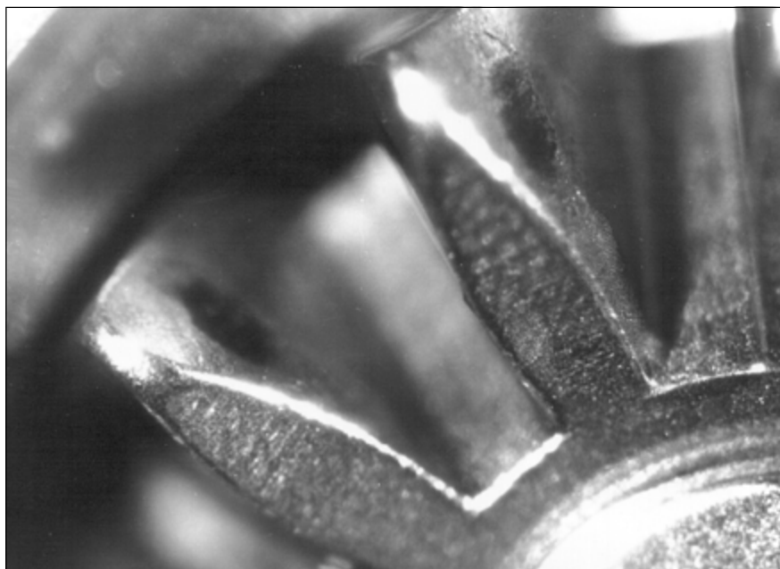
Abb. 2: Zwei Zahnradzacken des zweiten Triebeinsatzes des Schnellaufwinkelstückes A nach Instrumentengebrauch.
