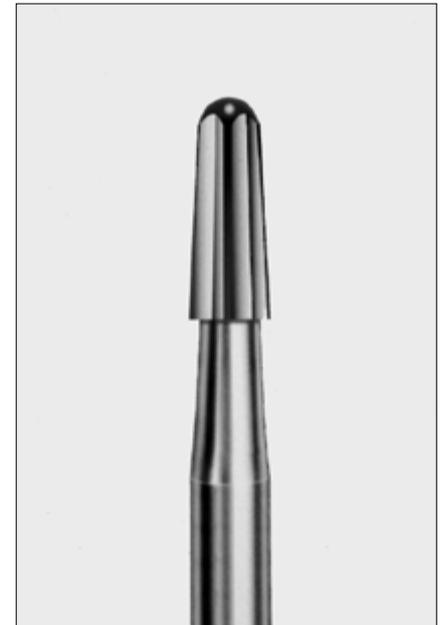
schmelz jedoch weitestgehend non-destruktiv verhält. Sie erzielen mit diesem Instrument feine Oberflächen bei geringer Anpreßkraft und nur minimaler Erwärmung. Einsatz im roten Winkelstück bei 160.000 min<sup>-1</sup>. Selbstverständlich ist der H22GK auch in der Turbine einsetzbar.
