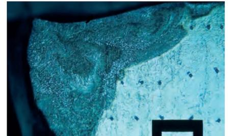
Abb. 10: Titan – Kehlnaht (TLL); Querschliff mit Mikrohärteeindrücken im Basismaterial erkennbar (in Schweißnaht wegen Aufhärtungen nicht sichtbar)
