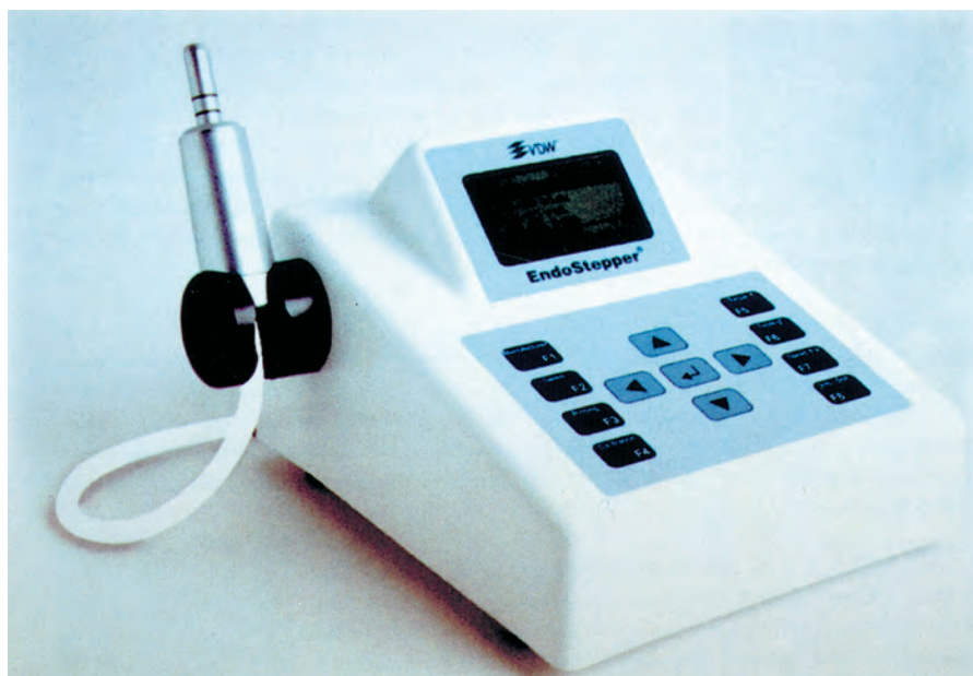
Abb. 2: Endo-Stepper (VDW) mit drehmomentbegrenztem Antrieb, Rüttelbewegung (Twist-Bewegung) und Software zur Einstellung der Drehmomentbegrenzung für die verschiedenen Instrumentengrößen der Nickel-Titan-Feilen Flex Master (VDW). In der Version EndoStepper (S.E.T.) verfügt das Gerät über eine Software zur Drehmomentbegrenzung verschiedener Edelstahl- und Nickel-Titan-Feilen.
