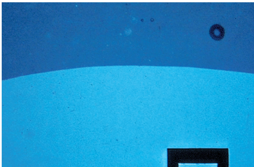
Abb. 7: Auflichtmikroskopische Darstellung des Verbundes CosmoPost und angepresste zirkonoxidhaltige IPS Empress-Keramik (Vergrößerung 500 x). Die Länge des weißen Balkens im schwarzen Rahmen beträgt 40 µm.
