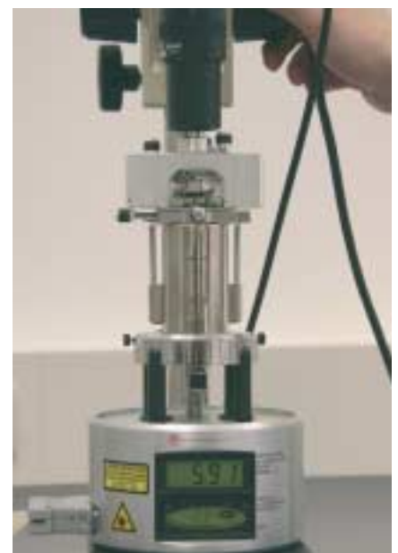
Abb. 3: Atomares Kraft-Mikroskop (AFM) in Kombination mit einem optischen Mikroskop (oben) am Institut für Materialwissenschaft der FSU Jena.
