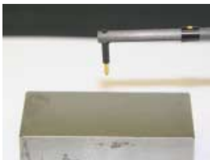
Abb. 2: Messspitze des Stylus-Profilometers. Die Länge des Hebels, an dem die Messspitze befestigt ist, beträgt ca. 5 cm.
