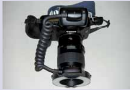
Abb. 6 a: Canon EOS 5D mit EF 100 mm Macro USM und Macro Ring Lite MR-EX14 Ringblitz
