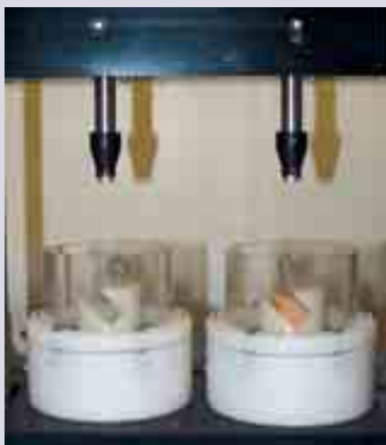
Abb. 1: Kausimulator Willitec: 1,2 \times 10^6 Zyklen Krafteinwirkung 50 N, 135^\circ , 1,3 Hz, 10.000 Thermowechsellasten: 5^\circ\text{C} und 55^\circ\text{C} = 5-jährige Tragedauer
