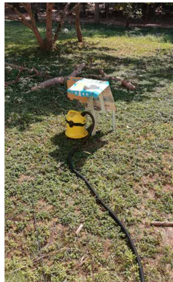
Die weite Entfernung des gelben Kärchers als provisorische Absaugeinrichtung vom Behandlungsplatz bis zur Wiese draußen machte den Lärm des Gerätes erträglich.
