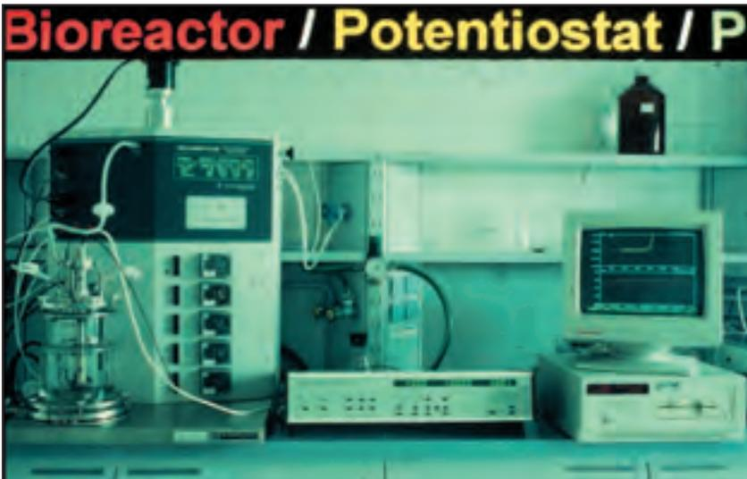
Abb. 21: Meßplatz zur Untersuchung von Korrosions- und Biokorrosionsvorgängen an metallischen Werkstoffen: Biorektor, Potentiostat und Coputer zur online-Datenverarbeitung
