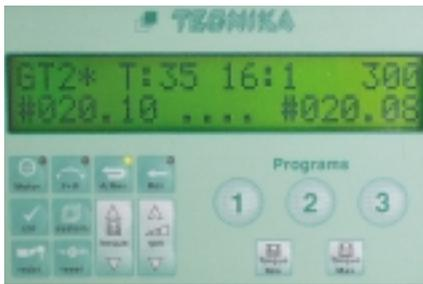
Abb. 6: Display und Folientastatur
