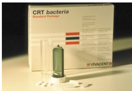
Abb. 10: Der CRT ist ein Doppeldipslide und gestattet den gleichzeitigen Nachweis von Streptococcus mutans und Laktobazillen auf hochselektiven Nährböden.
