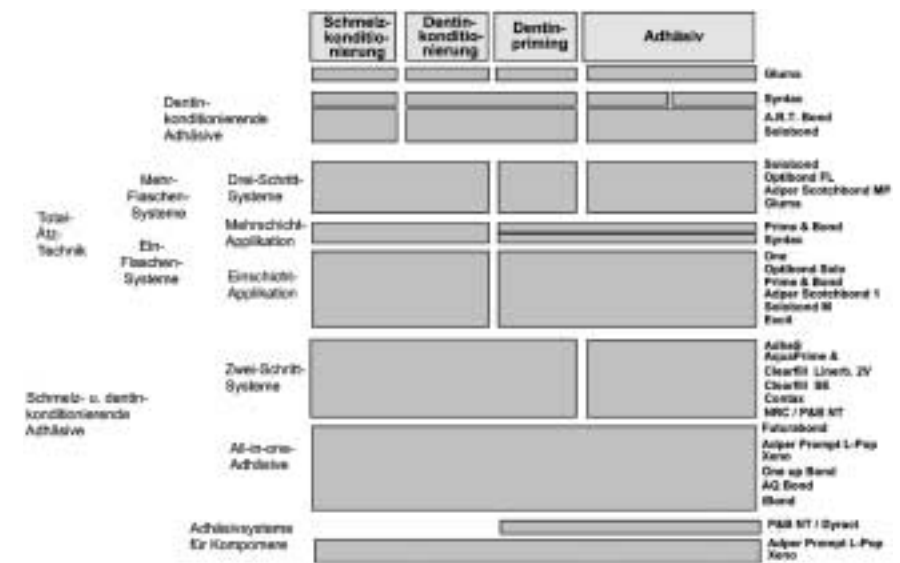
Abb. 6: Übersicht über die Adhäsivsysteme geordnet nach Gruppen gleicher Verarbeitungstechnik
