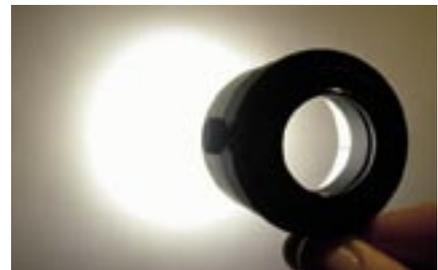
Abb. 7: Lichtkegel des LED-Vorsatzes
