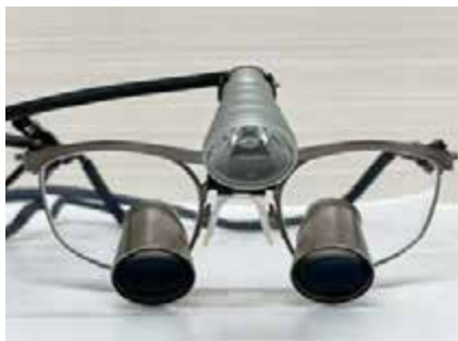
Abb. 4: Lupenbrille mit bis zu 5-facher Vergrößerung
