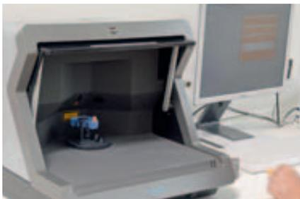
Maschinelle Herstellung (CAD/CAM) einer individuellen Krone
